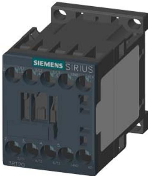
CONTACTOR, AC-3, 4KW/400V, 1NO, DC 24V,
