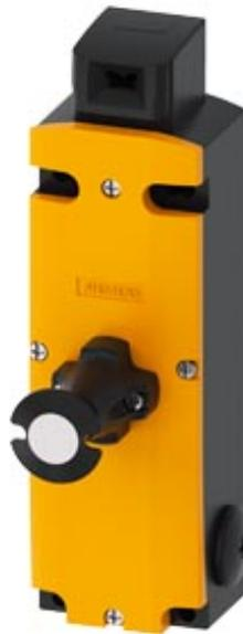
Interrupteur de position de sécurité à interverrouillage Force de verrouillage 2600 N 5 sens d'accostage Verrouillage par ressort Déverrouillage d'évacuation par l'avant Tension aimant 24V CC Surveillance du détrompeur 2 NF / 1 NO Surveillance de l'aimant 2 NF / 1 NO Livraison sans détrompeur. détrompeur 3SE5000-0AV0. à commander séparément
