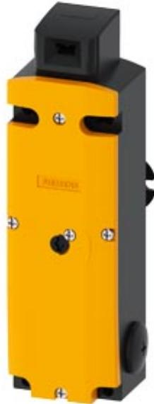
Interrupteur de position de sécurité à interverrouillage Force de verrouillage 2600 N 5 sens d'accostage Verrouillage par ressort Déverrouillage d'évacuation par l'arrière et déblocage auxiliaire à l'avant Tension aimant 115V CA Surveillance du détrompeur 2 NF / 1 NO Surveillance de l'aimant 2 NF / 1 NO Livraison sans détrompeur. détrompeur 3SE5000-0AV0. à commander séparément
