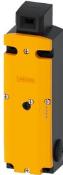
Interrupteur de position de sécurité à interverrouillage Force de verrouillage 2600 N 5 sens d'accostage Verrouillage par ressort débloccage auxiliaire à l'avant Tension aimant 24V CC Surveillance du détrompeur 2 NF / 1 NO Surveillance de l'aimant 2 NF / 1 NO Livraison sans détrompeur. détrompeur 3SE5000-0AV0. à commander séparément
