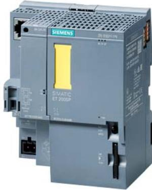
SIMATIC DP, CPU 1510SP F-1 PN pour ET 200SP, Module unité centrale avec 150 Ko de mémoire de travail pour le programme et 750Ko pour les données, 1. interface : PROFINET IRT avec commutateur 3 ports, performance sur bit 72 NS, carte mémoire SIMATIC nécessaire, adaptateur de bus nécessaire pour port 1 et 2
