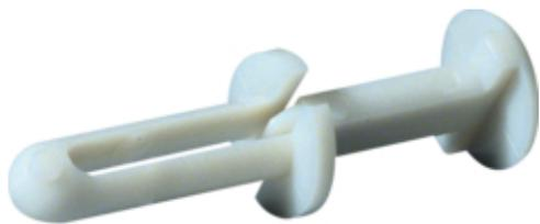
Rivet pour trou de perçage 4mm sans halogene résistance de serrage 2-5mm gris
