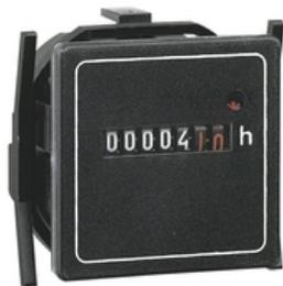
Compteur horaires totalisateur - 400 V - 50 Hz - dimension 48 x 48 mm - livré avec cadre de recouvrement (55 x 55 mm ) et accessoires de fixation
