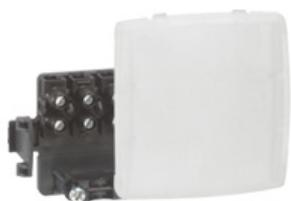
Oteo boîte de dérivation - équipée de 4 bornes pour conducteurs 2,5 mm<sup>2</sup> - composable (pour montage du mécanisme dans un cadre saillie ou cadre DLP)
