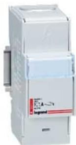
Répartiteur modulaire associable - unipolaire - 250 A - 11 connexions - 60 kA - 2 modules - permettent de réaliser par association un répartiteur tetrapolaire - avec porte-étiquette
