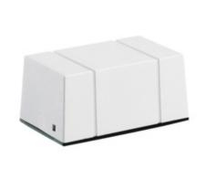
Transformateur pour sonnerie - 230 V - tension au secondaire 12-8 V - 1 A - 12 VA - dimensions (I x p x h) 92 x 56 x 42 mm - fixation murale à vis
