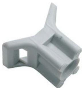
Embase à visser - gris - pour colliers Colson largeur maxi 9 mm - hauteur 12 mm pour goujon pistolet et tige à scellement diamètre 6,35 et 7, vis TF diamètre 5 mm
