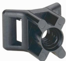
Embase à visser - noir - pour colliers Colson largeur maxi 9 mm - hauteur 12 mm pour goujon pistolet et tige à scellement diam. 6,35 et 7, vis TF diam. 5 mm
