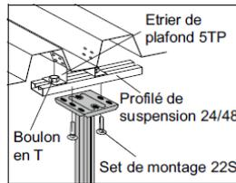
Montage du pendard 20 contre un plafond à profilés trapézoïdaux.
