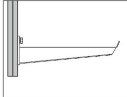
Une console 50 ou 50L est installée sur un pendard 20 à l'aide d'un boulon en T. Charges admissibles, voir console 50.
