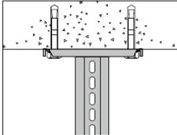
Installation d'un pendard 20 à l'aide de boulons d'expansion.
