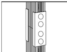
Le pendard 20 peut être rallongé à l'aide d'un profilé de suspension 24/20 et une éclisse d'assemblage 20J.
