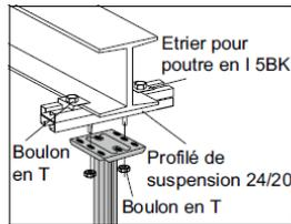
Le pendard 20 est fixé à une structure en acier comme indiqué. Avec des flasques jusqu'à 13 mm, utilisez l'étrier pour poutre en I 5BK-10 et des boulons en T 26F/40. Avec des flasques jusqu'à 30 mm, utilisez l'étrier pour poutre en I 5BK-30 et des boulons en T 26F/50.
