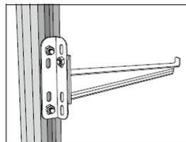
Une console peut être installée à 90° par rapport au profilé de suspension, à l'aide de l'équerre HT-11. Uniquement pour charges légères, telles que câbles de transmission de données.
