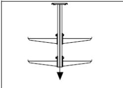
Charge de rupture du pendard 20 sous charge symétrique = 3000 kg (30 kN).
