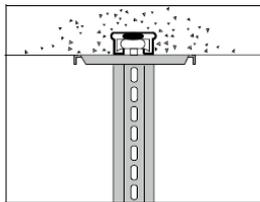
Installez le pendard 20 sur un rail à encaster à l'aide d'un boulon en T.
