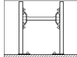
Une ou plusieurs échelles à câbles peuvent être montées à l'aide de pendards 2F, étriers pour profilés 41 et boulons en T. Les pendards sont fixés sur le sol.
