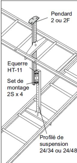
Il est possible de croiser les échelles à plusieurs niveaux à l'aide d'un pendard et une équerre HT-11.
