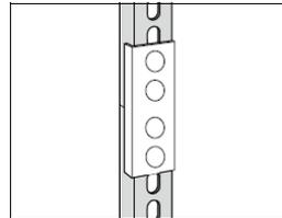
Le pendard 2F peut être rallongé à l'aide du profilé de suspension 24/48 et de l'éclisse d'assemblage 2FJ.
