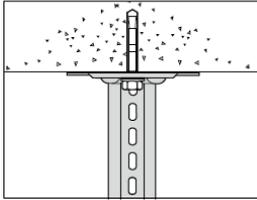
Installez un pendard 2F à l'aide d'un boulon d'expansion.
