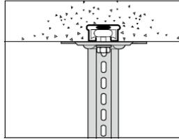
Installez un pendard 2F sur un rail à encastrer à l'aide d'un boulon en T.
