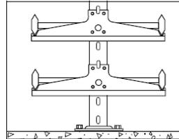
Echelles à câbles montées sur pendard 2F et support console 3.
