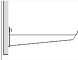
Une console 50 ou 50L est installée sur un pendard 2F à l'aide d'un boulon en T.
