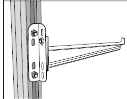
Une console 50 ou 50L peut être installée à 90° par rapport au profilé de suspension, à l'aide de l'équerre HT-11. Uniquement pour charges légères, telles que câbles de transmission de données.
