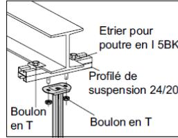
Le montant de pendard 2F est fixé à une structure en acier comme indiqué. Avec des flasques jusqu'à 13 mm, utilisez l'étrier pour poutre en I 5BK-10 et des boulons en T 26F/40. Avec des flasques jusqu'à 30 mm, utilisez l'étrier pour poutre en I 5BK-30 et des boulons en T 26F/50.
