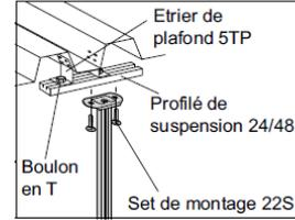
Montage du pendard 2F contre un plafond à profilés trapézoïdaux.
