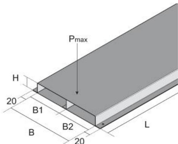
La gaine de sol fermée à section rectangulaire est fabriquée en tôle d'acier galvanisée Sendzimir. La gaine de sol est divisée en 2 compartiments par une cloison de séparation intermédiaire. Les parties supérieures et inférieures sont solidement assemblées. Les trous de forage intégrés dans le rebord serti facilitent la fixation au plancher avec des chevilles à frapper UN 5/38.
