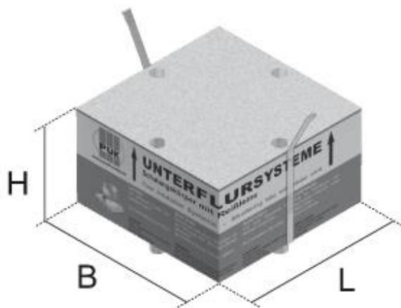
Le corps de coffrage est fabriqué en Styropor et est revêtu d'une matière synthétique.
