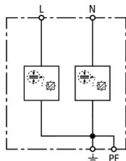
Schéma de principe du circuit DSH TN 255
