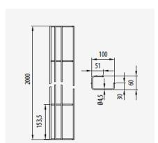
Le treillis de plafond est fabriqué en fils d'acier zingués électrolytiquement selon NBN EN ISO 2081. L'épaisseur de la couche de protection grise varie entre 8 et 12 µm.
