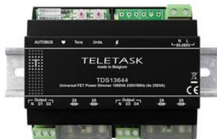
Le TDS13644 est un variateur de puissance sur AUTOBUS à quatre canaux pour une variation à 230V/50Hz des lumières traditionnelles, LED et autres lumières graduables. Le variateur peut également commander des lampes et des LED qui sont branchées sur des transformateurs traditionnels et électroniques. Ainsi, le gradateur peut être configuré pour fonctionner en coupure de début (Leading) ou de fin (Trailing) de phase.
