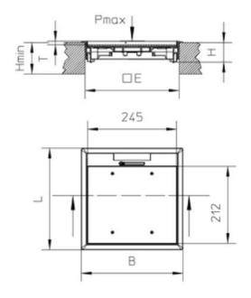
Le rebord, le couvercle auto-fermant avec sortie latérale et le levier auto-fermant, sont fabriqués en polyamide, d'une couleur gris mat ou noir mat.
