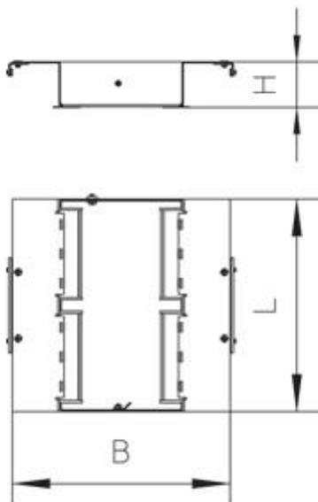
Le cadre d'appareillage pour structures de sol basses est fabriqué en tôle d'acier galvanisée Sendzimir.
