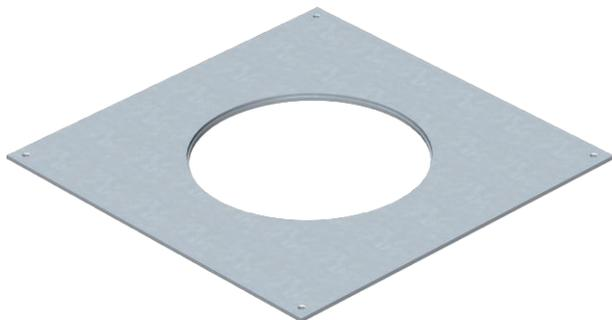
Couvercle de montage pour boîtes de tirage et de dérivation sous chape de type UZD250-3 destinée au montage d'un boîtier de sol de taille nominale R4. Ouverture de montage évidée de 3 mm pour la fermeture ultérieure totale à l'aide d'une plaque d'obturateur.
