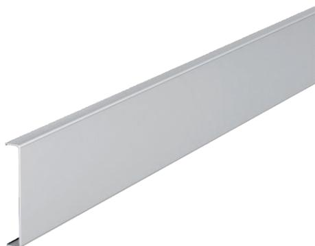
Couvercle en aluminium pour la fermeture des canaux d'allège GA Rapid et des colonnes d'installation ISS avec une ouverture du système de 76,5 mm. La mise en place ferme du couvercle et les contacts électriques du socle de la goulotte/colonne est garantie par des pinces de fixation de type RKV3V. 6 pinces de fixation sont prémontées dans chaque longueur disponible (2000 mm).
