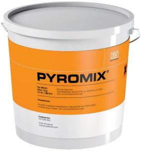
Mortier coupe-feu pour le calfeutrement de pénétration de câble et de pénétration mixte dans les murs maçonnés et dalles béton. Application par pompage, presse ou manuelle. 10 kg de mortier sec donnent environ 10 litres de masse prête à l'emploi en rajoutant env. 3 litres d'eau. Dans les pièces sèches et froides, mais à l'abri du gel, le mortier sec peut être stocké dans l'emballage d'origine fermé pendant au moins 12 mois.
