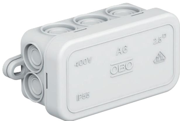
Indice de protection IP55, tension nominale 400 V, section nominale 2,5 ÷ mm<sup>2</sup>, 6 entrées pour diamètres de câble 5-14 mm
