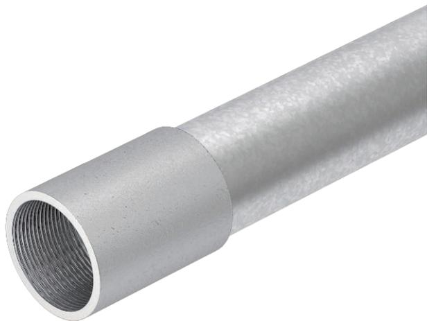
Tube d'installation électrique selon EN 61386-1 avec extrémités filetées selon la norme DIN EN 60423, pour la protection mécanique de câbles et de fils. Avec paroi intérieure sans ébarbure. Classe de protection anticorrosion 4 (élevée). Un manchon de raccordement est déjà vissé sur chaque tube.
