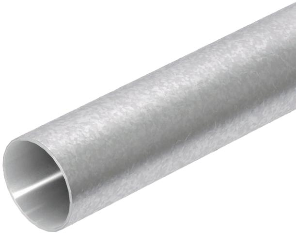
Tube d'installation électrique sans extrémités filetées selon la norme EN 61386-1, pour la protection mécanique de câbles et de fils. Avec paroi intérieure sans ébarbure. Classe de protection anticorrosion 4 (élevée).
