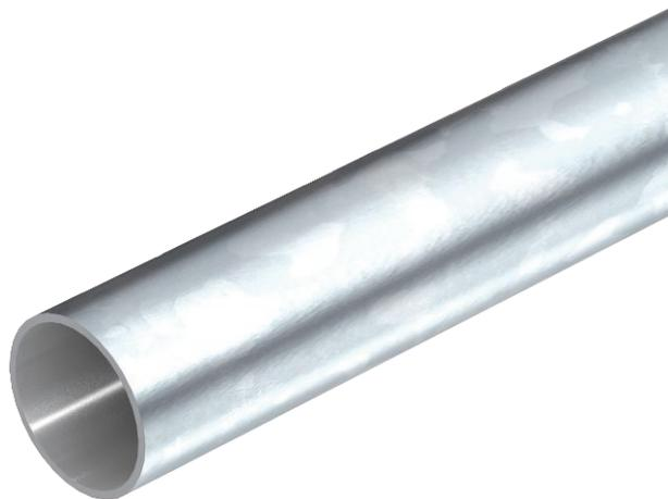
Tube d'installation électrique sans extrémités filetées selon la norme EN 61386-1, pour la protection mécanique de câbles et de fils. Avec paroi intérieure sans ébarbure. Classe de protection anticorrosion 2 (moyenne).
