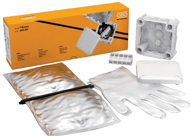
Ensemble composé d'une boîte de dérivation T 60 avec bornier de raccordement, de résine coulée et d'une paire de gants jetables. Résine coulée bicomposant dans un sac de mélange pour protéger l'installation électrique contre l'humidité selon la classe de protection IP 68 et les charges mécaniques.
