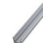
Profilé plein, Profil standard, largeur: 35 mm, hauteur: 15 mm, similaire à EN 60715, matériau: Aluminium, aucun revêtement, longueur: 2000 mm, coloris: argenté
