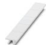
Repérage ZB, Rubans, blanc, vierge, repérable avec : PLOTMARK, CMS-P1-PLOTTER, type de montage: encliquetage dans la rainure de repérage élevée, pour bloc de jonction au pas de : 15,2 mm, surface utile: 10,5 x 15,1 mm, Nombre d'étiquettes: 5
