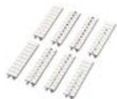
Repérage ZB, Rubans, blanc, repéré, repérable avec : Traceur, impression longitudinale: chiffres identiques 1 ou 2, etc. jusqu'à 100, Type de montage: Encliquetage dans la rainure de repérage élevée, pour BJ au pas de : 5,2 mm, Surface utile: 5,15 x 10,5 mm
