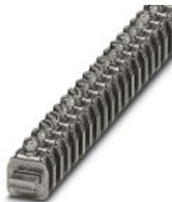
BJ, Type de raccordement Raccordement vissé, Courant de charge: 41 A, section : 0,5 mm<sup>2</sup> - 6 mm<sup>2</sup>, Largeur: 7 mm, Coloris: argenté
