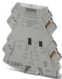
Amplificateur-séparateur à 3 voies avec connectique enfichable et commutation calibrée de la plage de mesure pour l'isolation galvanique de signaux analogiques unipolaires et bipolaires. Entrée et sortie configurables par sélecteur de codage (DIP). Raccordement vissé, configuration standard
