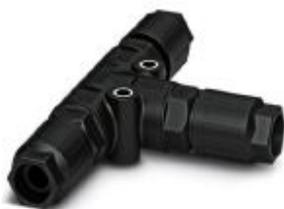
Répartiteur en T, Raccordement QUICKON, nombre de pôles: 2+PE, 0,5 mm<sup>2</sup> ... 1,5 mm<sup>2</sup>, 690 V, 17,5 A, noir, avec 3 écrous QUICKON, plage de diamètre de câble: 5 mm ... 9,5 mm
