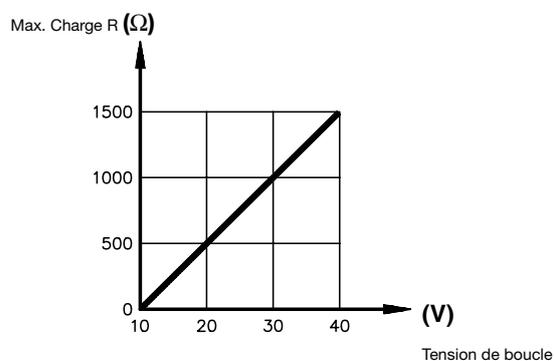
Résistance charge max vers tension de boucle
