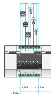
Ce module vous permet de commander six circuits différents, par exemple des points d'éclairage, des prises de courant ou des vannes de régulation. Chaque contact peut aussi être commandé manuellement à l'aide d'un bouton. Le module permet de relier deux neutres en vue d'un câblage ordonné dans le coffret électrique. Muni de six LED de feed-back et d'une LED de statut, il consomme très peu d'énergie.
