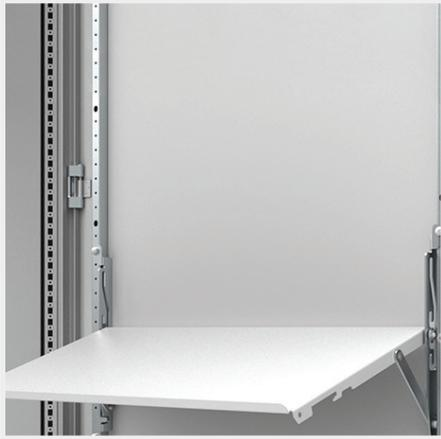
**Description:** Montée directement sur le cadre de porte, elle forme une surface de travail robuste pour des documents, un ordinateur ou des appareils de mesure. Cette tablette peut facilement être repliée et s'encastre dans le cadre de porte. Un système de positionnement automatique de sécurité bloque la tablette à 55°, 70° et 90°. La DDK800R5 peut également être montée sur une porte de 1000 mm de large à l'aide de l'accessoire DCP1002.
