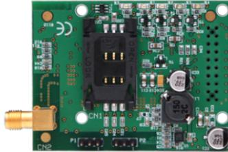
Carte d'extension transmetteur GSM pour centrales série VEDO. Permet de faire des appels téléphoniques, d'envoyer des SMS, MMS et des mails sur le réseau DATA. Associée à la carte messages vocaux art. 30001303, permet le contrôle à distance de la centrale via SMS et transmetteur vocal.
