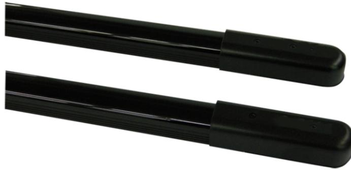
Paire de barrières IR, 3 rayons doubles, d'intérieur ou d'extérieur, hauteur 1 m. Portée 20 m (intérieur), 10 m (extérieur). Tension d'alimentation 12 Vcc, consommation 0,6 W, indice de protection IP54. Dimensions (L x H x P) : 25 x 1000 x 22 mm, coloris noir.
