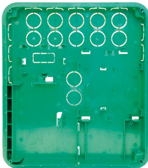
Boîtier à encastrer en plastique antifeu pour cartes centrale série VEDO art. 30001208, 30001234 et 30001268. Couvercle blanc RAL 9003. Peut accueillir la batterie 7 A/h, l'alimentation art. 30076101 et jusqu'à 2 cartes d'extension sur bus. Dimensions (L x H x P) 310 x 350 x 75 mm.
