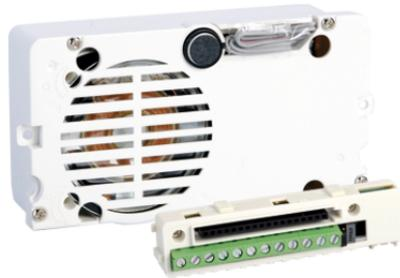
Unité audio pour système 2-fils avec bornier et gestion de la phonie avec rattrapage automatique de l'écho, haut-parleur étanche, micro à électret et volume du haut-parleur réglable par l'avant. Équipé de microprocesseur et dip-switch pour la programmation. Fonction électronique ouvre-porte (3A), plus relais contacts C, NF, NO de 10A. Entrées ouvre-porte temporisées et indication de porte ouverte. Compatible avec l'alimentation art. 1210. Dimensions: 102x55x38 mm.
