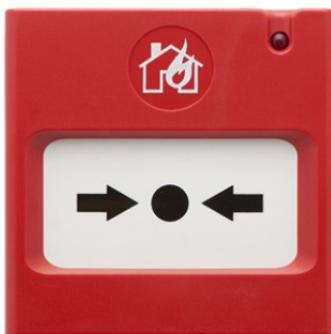
Point d'alarme manuel adressé avec isolateur embarqué. Le bouton présente un élément de déclenchement réinitialisable avec un badge spécial en plastique (fourni) et il envoie un signal d'alarme à la centrale dès que l'on appuie dessus. Une led signale l'état d'alarme ou de test. Montage en saillie. Boîtier en ABS rouge. Conforme EN 54-11 et EN 54-17.
