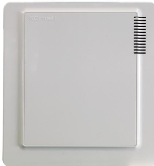
Centrale d'alarme série VEDO, boîtier mural en ABS ininflammable, avec alimentation à découpage 1,5A. Equipée de 8 entrées zones sur carte, extensibles jusqu'à 200 zones mixtes filaires/radio, 1 zone 24 heures, fonction double pour un maximum de 400 zones
