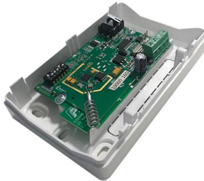
Modules émetteurs/récepteurs radio permettant d'utiliser les dispositifs sans fil répertoriés dans les centrales Comelit de la série VEDO. Ils permettent d'utiliser jusqu'à 32 capteurs, 16 sirènes et 32 télécommandes radio. Disposé dans un conteneur en plastique ignifuge blanc complet avec anti-ouverture et anti-arrachement . Il peut également être disposé à l'intérieur des conteneurs art. BOXPLASTIC, BOXMETAL et BOXFLUSH. Dimensions (L x H x P) 126 x 80 x 32 mm.
