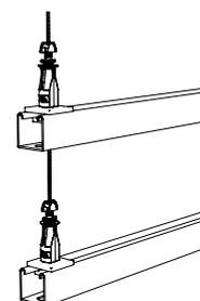
Angle maximal à partir de l'axe vertical = 15° (sauf stipulé autrement par le service technique de Gripple)
