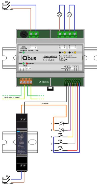
Avec alimentation 5-24 V supplémentaire pour le feed-back par LED sur les poussoirs. Ici, en combinaison avec un interrupteur Niko type 170-401Y1 ou 170-401Y0
