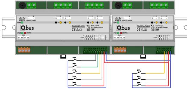
Plusieurs modules DIM02SA peuvent être reliés entre eux ou avec d'autres modules de la gamme SA (REL04SA, DIM04SA, ANR04SA).
