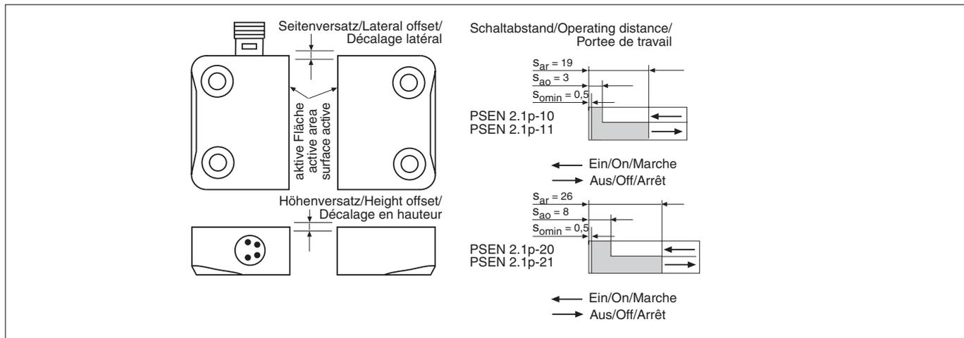
**Seiten- und Höhenversatz/Lateral and height offset/Décalage latéral et Décalage en hauteur**
