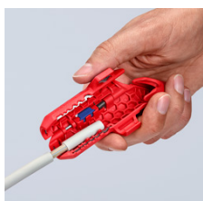
Ontmantelen van een NYM-kabel
